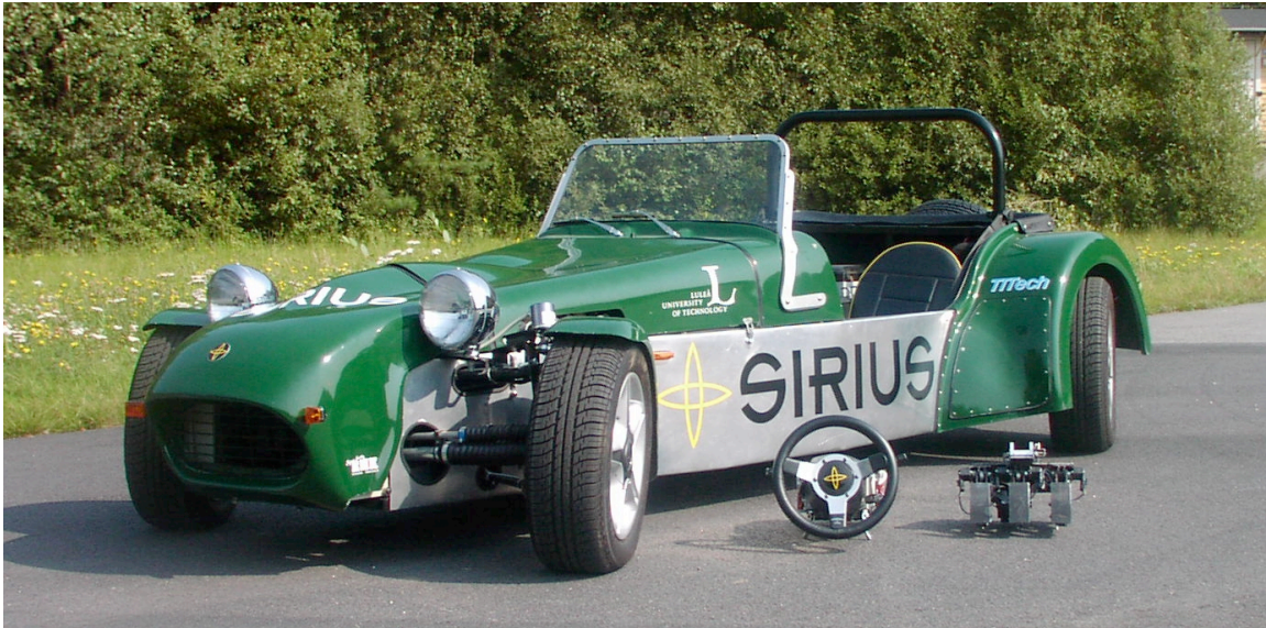
SIRIUS-bilen som konstruerades tillsammans med Luleå Tekniska Universitet under 2001 för att visa på möjligheter med drive-by-wire teknik och få erfarenheter från tekniken.
